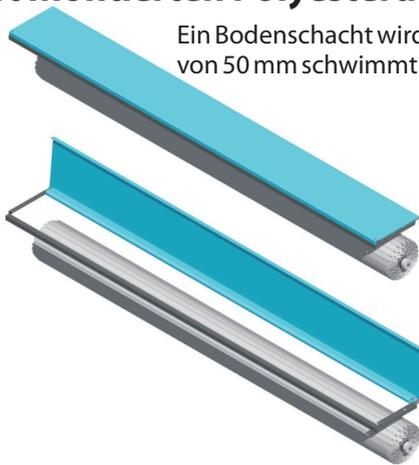
Ein Bodenschacht wird mit einem Polyesterdeckel abgedeckt der fest montiert wird. Durch eine Öffnung von 50 mm schwimmt die Abdeckung nach oben.
